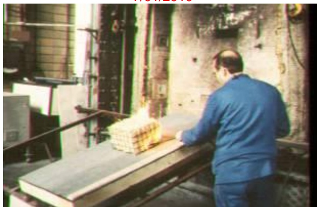
Afbeelding 13 - Illustration de l'essai "test 1" de la NBN ENV 1187
